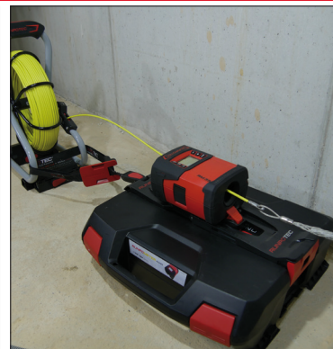
RM35 Rögzítő lappal és rendszer kofferrel, Üvegszálás berudalóval
