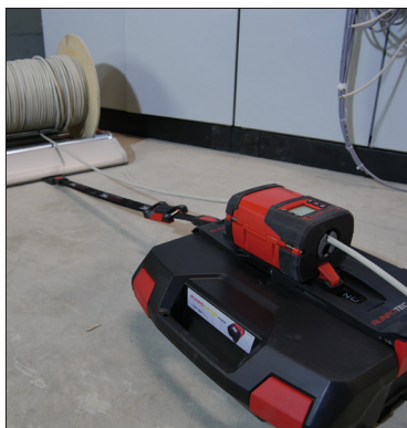
RM35 hevederrel és Rögzítő paddal összekötve a PRO670 kábeldobcsévélővel
