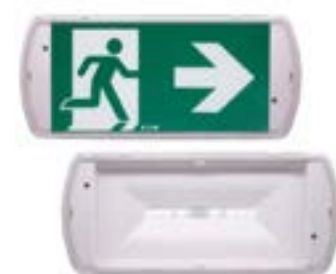
Vészvilágító LED 2h készenléti/állandó átkapcsolható IP42 SL20 oldalfali EATSL2MNM42C2C3A
