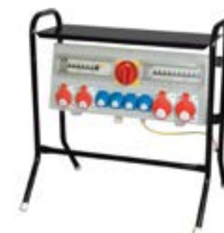
Felvonulási szekrény állványon ROS24S/FI- 01/S (2db 5P 16A + 2db 5P 32A dugalj, 4db 2P+F 16A háztartási dugalj, 2db 3C16, 2db 3C32, 4db 1B16 A kismeg- szakító, 1db 4P 63A/30mAFi-relé, 1db 63A biztonsági kapcsoló) SEZ1000880000
