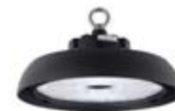
Csarnokvilágító LED 150W 22500lm 4000K IP65 120° függeszthető STP LED UFO VI STR70401150501
